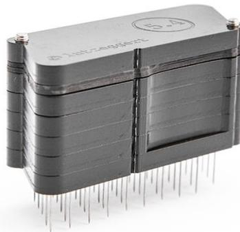
Figura 3 - Lo strumento utilizzato per l'esecuzione del test, dotato di 50 aghi distanziati di 5,4mm
